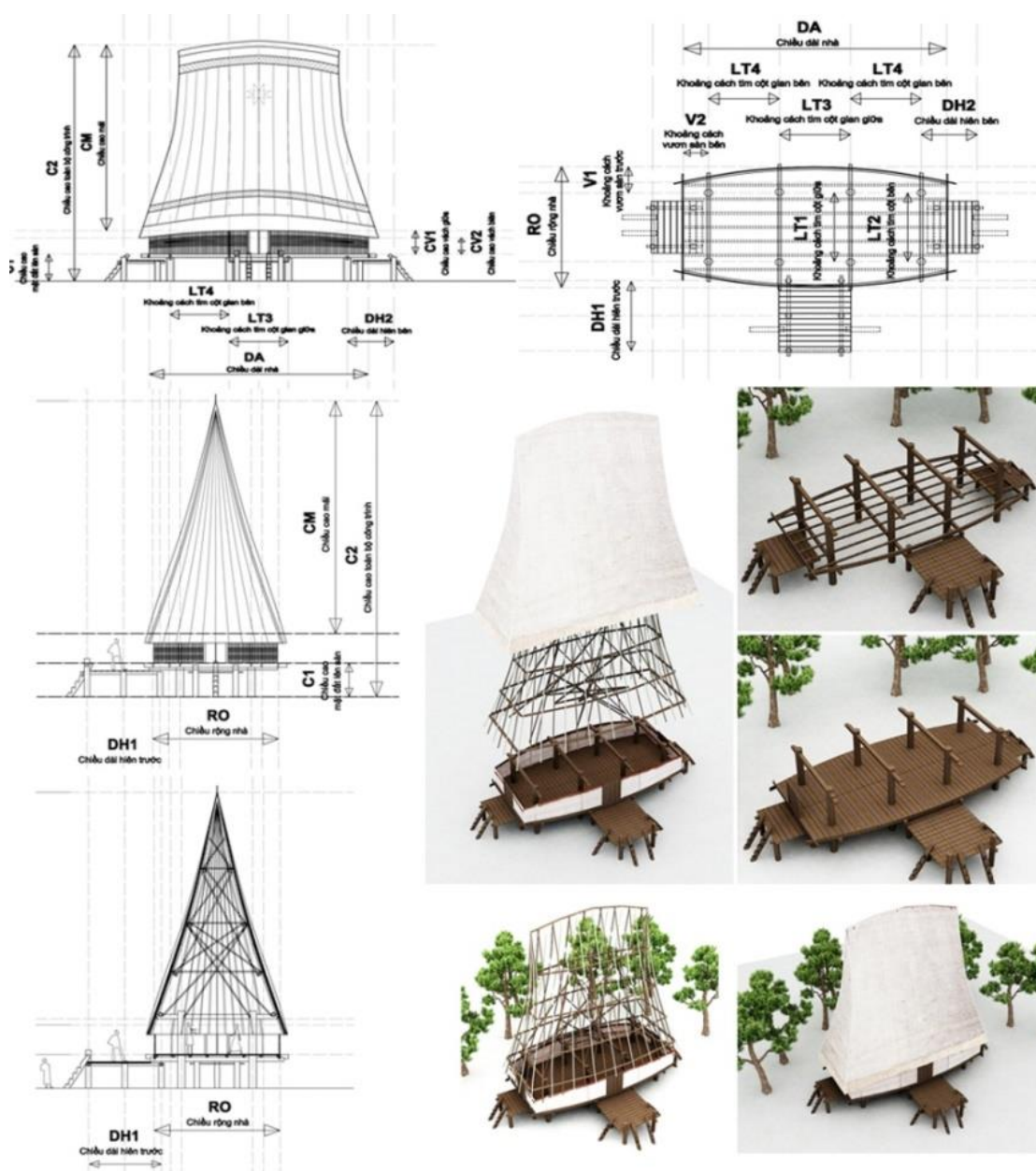
Hình 05. Mô hình 3D hệ kết cấu nhà Rông Ba Na điển hình tại thành phố Kon Tum (Nguồn: Tác giả)
